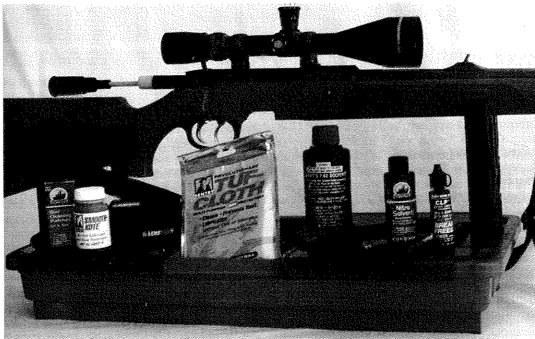
清洁狙击步枪时使用的各种溶剂和润滑剂。注意一段式通条和线膛导具。
