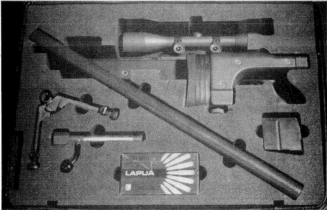
与箱体结合紧密的 AW (Covert) 秘密步枪, 其消音器长度与枪管相同。
