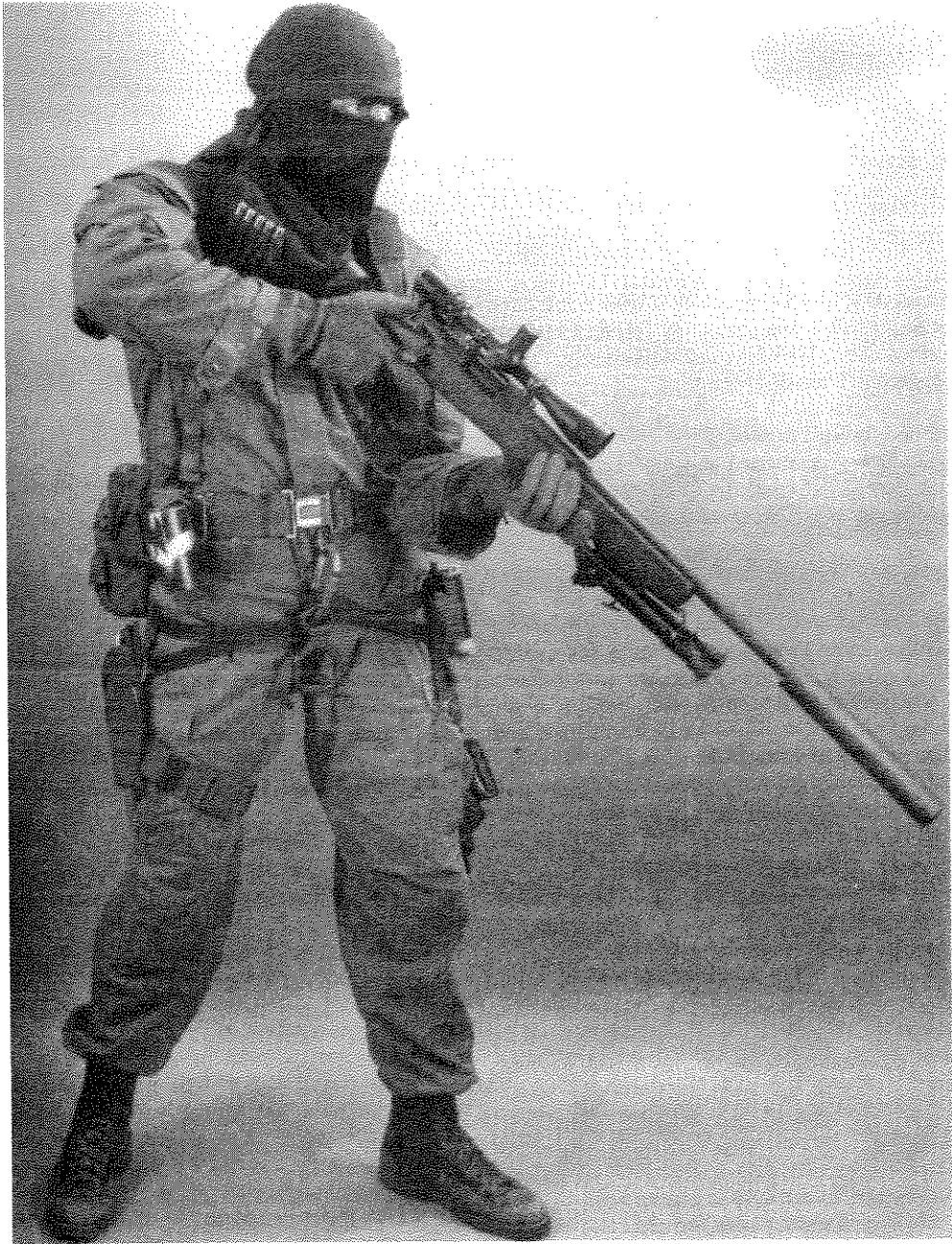
这款 AWC M92 步枪上安装了频谱(Spectrum)2000 消音器。
